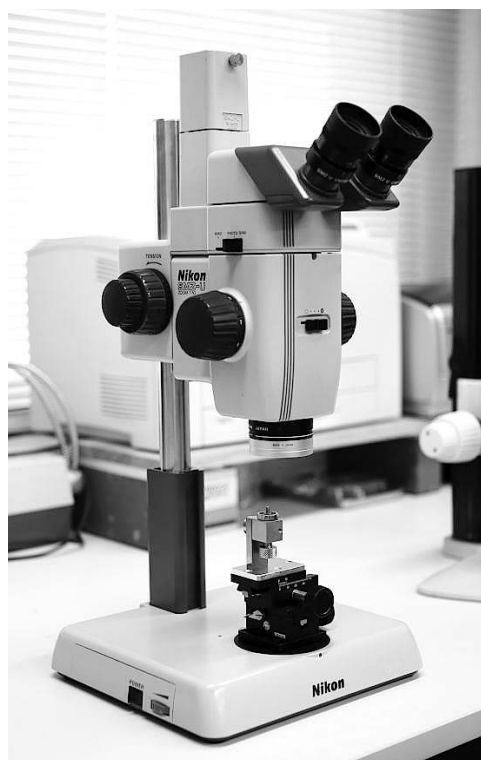
図4 ステージを実体顕微鏡に取り付けた状態を図4に示す。
