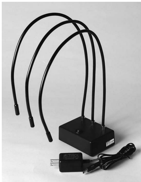
図5 製作したトリプルアームLED照明装置
