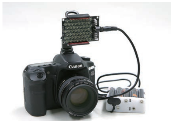
図 7 ホットシューに取り付けた赤外線 LED ユニット
