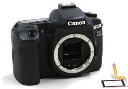
図1 改造した EOS 40D と取り外したローパスフィルター
