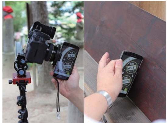
図6 スマートフォンで傾斜を測り平行を出す
