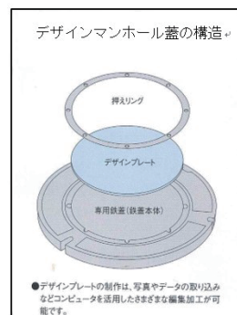
図8 デザインマンホール蓋の構造 小田原市 HP より引用 ( https://www.city.odawara.kanagawa.jp/field/water/sewer/sewer/p29201.html 2023/03/03 閲覧)
