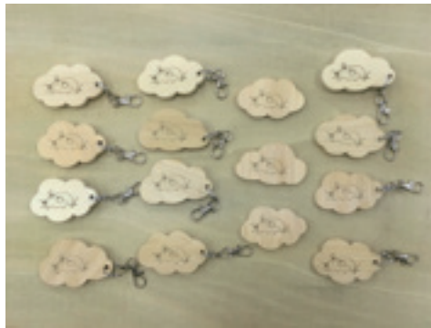
図 1-12 「路地グルメ」の賞品、木製キーホルダー (糸ノコとレーザーで刻印、木部 50×80 程度)
