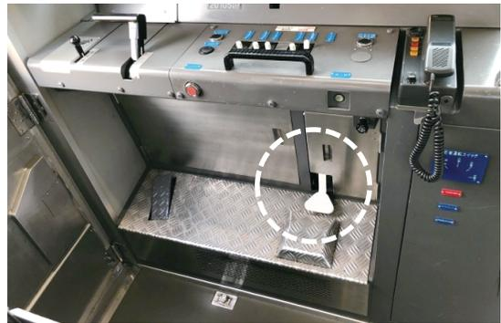
図2. 電車の運転室に設置されている気笛吹鳴装置(図中に破線で示したもの)
