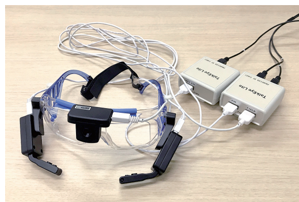
図1 使用した視線計測グラス
